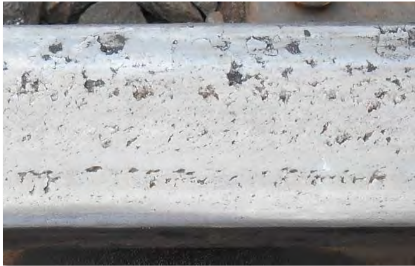
Rolling contact fatigue (RCF)
